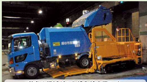
黄色の機械がごみ投入検査機です。 ごみ収集車1台分のごみ内容をすべて検査します。
